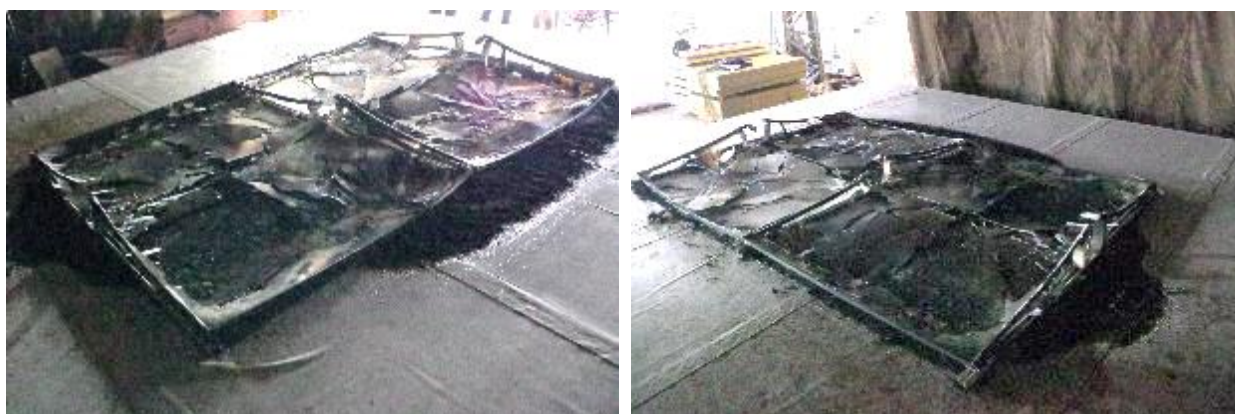
Fot. 4 Zniszczenia na powierzchni próbkę z panelami UKŁAD – 1 (zdjęcie autora opracowania)
