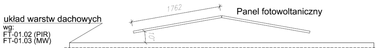
Rys. 8 Układ paneli fotowoltaicznych – widok z boku (rysunek dostarczony przez Zleceniodawcę)
