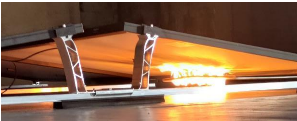
Fot.3 Położenie palnika podczas badania (zdjęcie wykonane przez autora opracowania)
