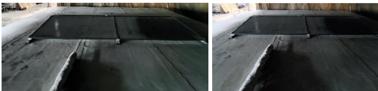
Fot. 1 Widok układu dachowego z wełną mineralną przed badaniem oraz widok konstrukcji mocującej panele fotowoltaiczne (zdjęcie wykonane przez autora opracowania)
