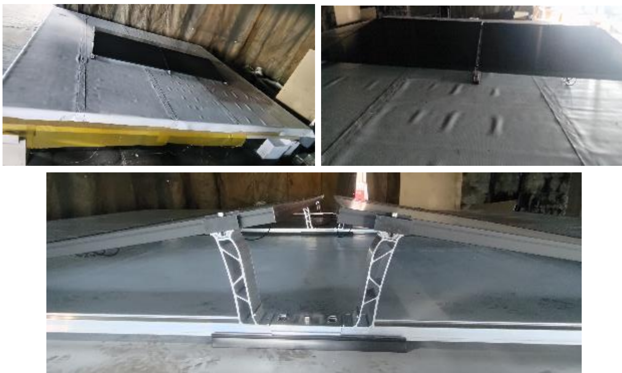
Fot. 1 Widok układu dachowego z wełną mineralną przed badaniem oraz widok konstrukcji mocującej panele fotowoltaiczne (zdjęcie wykonane przez autora opracowania)
