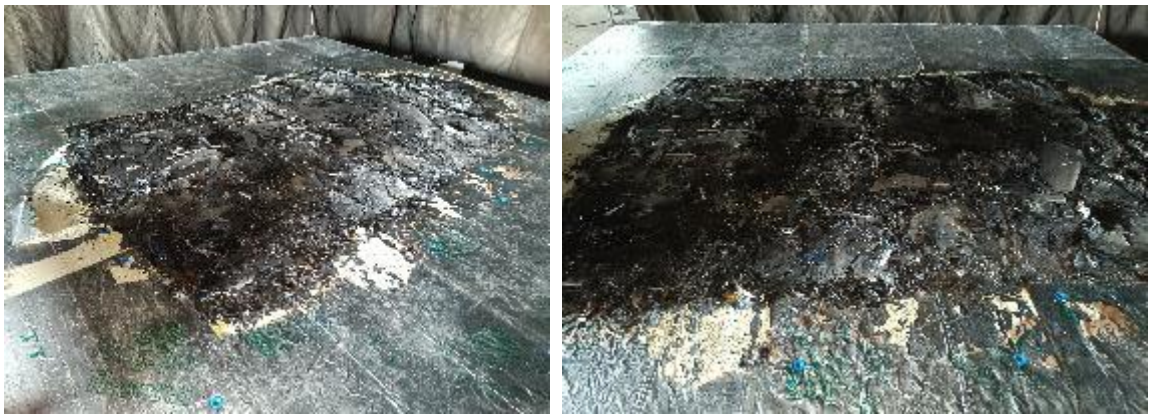
Fot. 13 Zniszczenia na powierzchni próbki po zdjęciu membrany dachowej UKŁAD – 2 (zdjęcie autora opracowania)
