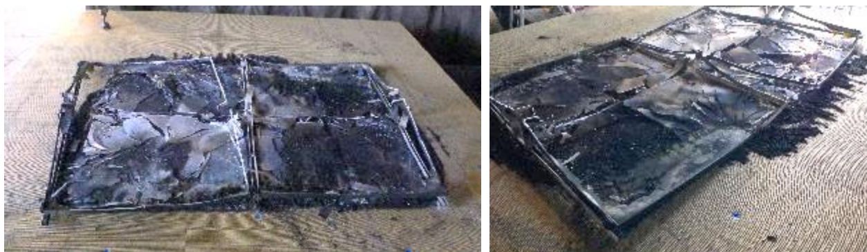
Fot. 5 Zniszczenia na powierzchni próbkę po zdjęciu membrany dachowej UKŁAD – 1 (zdjęcie autora opracowania)
