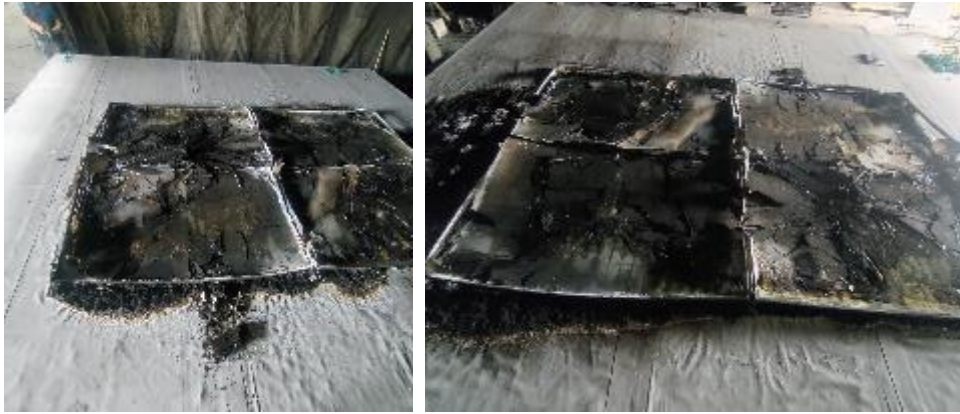
Fot. 12 Zniszczenia na powierzchni próbki próbka z panelami UKŁAD – 2 (zdjęcie autora opracowania)
