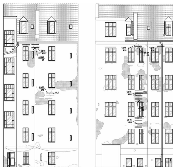
Wzmocnienie elewacji ścian zewnętrznych od strony podwórza [5] Strengthening external walls – elevations from the courtyard [5]
