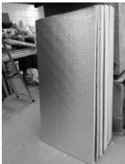
Płyty warstwowe z rdzeniem z pianki poliuretanowej w okładzinach aluminiowych Photo 1. Sandwich panels with a polyurethane foam in aluminum lining
