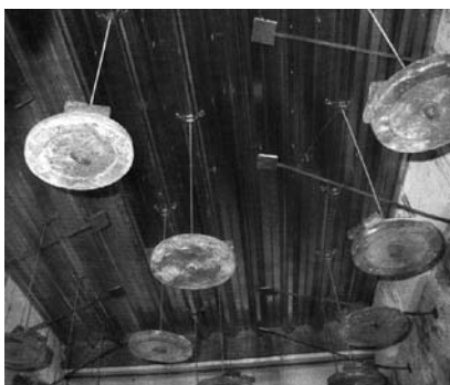
Fot. 2. Badana próbka od spodu – widoczne dyski metalowe symulujące obciążenie technologiczne podwieszono do spodu blachy trapezowej
