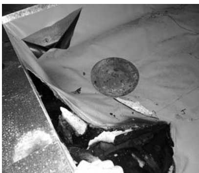
Fot. 1. Testowana próbka po zakończonym badaniu – widoczna czarna zwęglina na obrzeżach przelamanych płyt PIR
