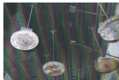
Fot. 2. Badana próbka od spodu – widoczne dyski metalowe symulujące obciążenie technologiczne podwieszono do spodu blachy trapezowej
